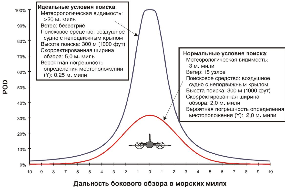
Рис. 4-13. Пример кривых вероятности обнаружения при визуальном поиске за один проход [объект поиска: шлюпка длиной 7 м (23 фут)]
