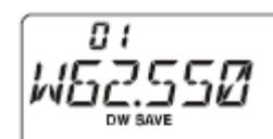
приоритетного канала при настройке на канал метеосводок. На дисплее останется частота канала метеосводок, однако радиостанция будет каждые пять секунд проверять активность приоритетного канала (канала памяти).
