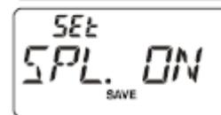
Если функция разделения тонов включена, то в списке, вызываемом при нажатии кнопок **[F/L]→[1(SQ TYP)]** во время выбора режима доступа, следом за DCS появятся дополнительные опции:
