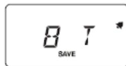
Если в сигнале, передаваемом вызывающей станцией, содержится тон CTCSS, код DCS или пара кодов CTCSS, на которые настроен декодер, звуковой сигнал активируется в соответствии с заданными настройками. Когда функция звукового оповещения в режиме CTCSS/DCS/EPCS активирована, в верхнем правом углу ЖК-дисплея отображается значок **▼**.
