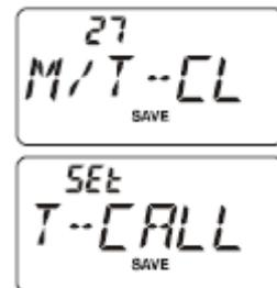
Для доступа к ретранслятору нажмите и удерживайте кнопку **MONI** в течение промежутка времени, указанного владельцем/оператором ретранслятора. Передатчик автоматически включится, после чего в эфир будет передан сигнал, содержащий звуковой тон с частотой 1750 МГц. После получения доступа к ретранслятору следует отпустить кнопку **MONI**, а затем включить передатчик с помощью тангенту **PTT**.
