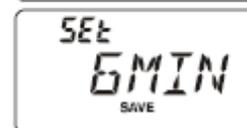
4. С помощью регулятора **DIAL** выберите для таймера отключения передатчика желаемое максимальное время передачи (от 1 до 30 минут) или деактивируйте функцию TOT.
