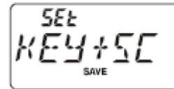
KEY: сигнал звучит при нажатии кнопок.
