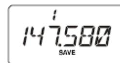
3. С помощью регулятора **DIAL** настройтесь на новую частоту. Она будет меняться с шагом, выбранным для данного диапазона в режиме настройки частоты.
