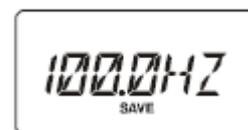
5. Нажмите кнопку **[F/L]**, затем нажмите кнопку **[2(CODE)]**, чтобы разрешить изменение частоты тона CTCSS.
