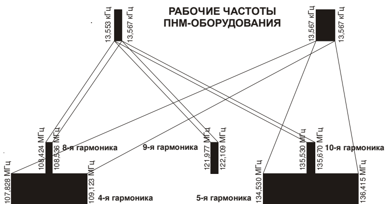
Рис. 9-2. Рабочие частоты ПНМ-оборудования
