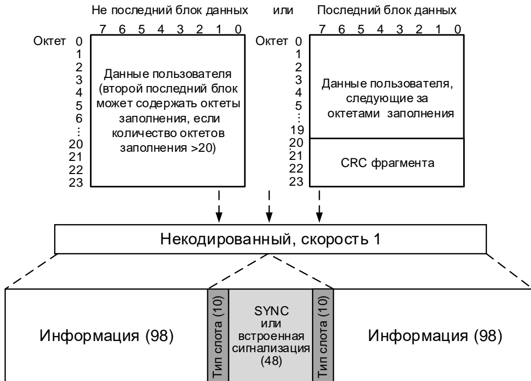
Рисунок 8.13 – Формат неподтвержденного блока данных со скоростью кодирования 1
