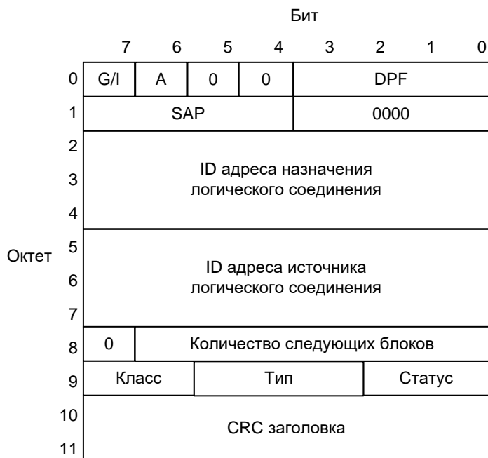
Рисунок 8.5 – Специальный первый блок заголовка для пакета ответных данных
