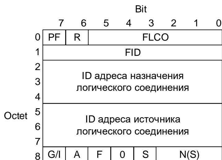
Рисунок 8.18 – Канал управления связью Терминатор Данных
