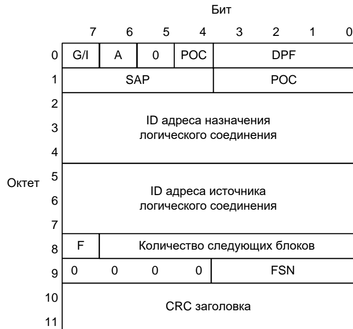
Рисунок 8.3 – Специальный первый блок заголовка для неподтверждаемого пакета
