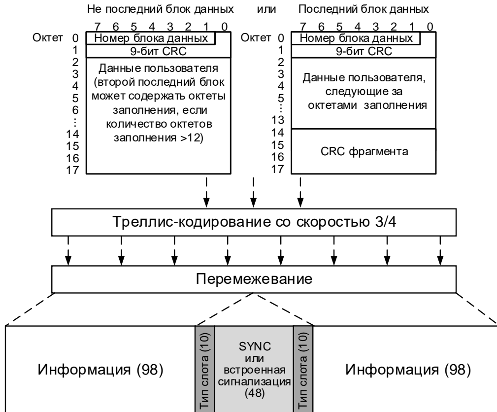
Рисунок 8.14 – Формат подтверждаемого блока данных со скоростью кодирования 3/4
