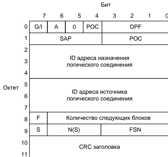
Рисунок 8.4 – Специальный первый блок заголовка для подтверждаемого пакета
