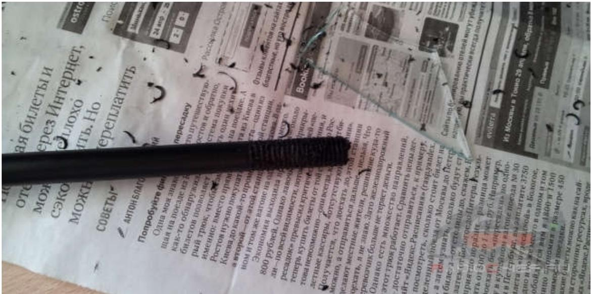
Обрезаем внешнюю изоляцию на нужное расстояние.
