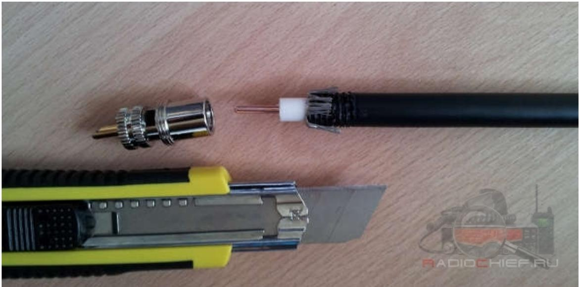
Пассатижами накручиваем разъем на кабель, не забыв заранее одеть термоусадку. Мощным паяльником припаиваем центральную жилу.
